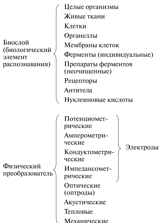
Схема 1. Типы чувствительных элементов распознавания (биослой) и физических преобразователей в сенсорах.
